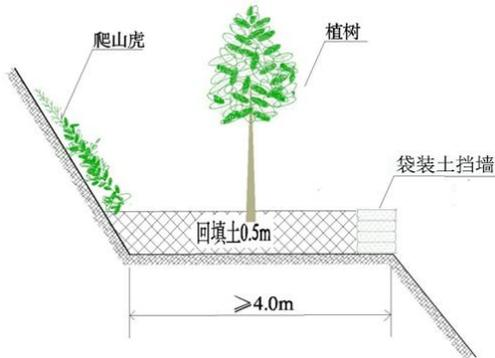
图 5-2 台阶复垦设计示意图
