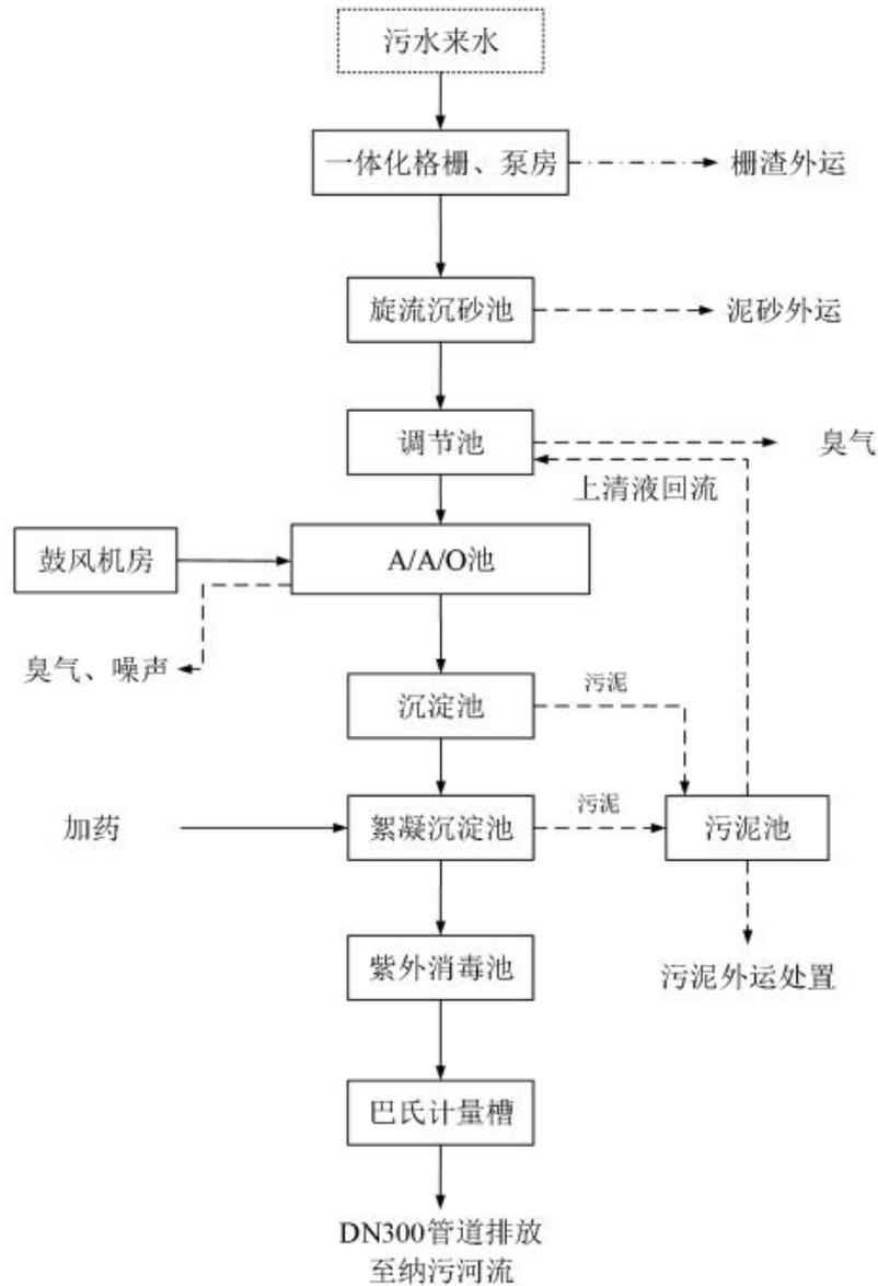
图 2-1 污水处理工艺流程图
