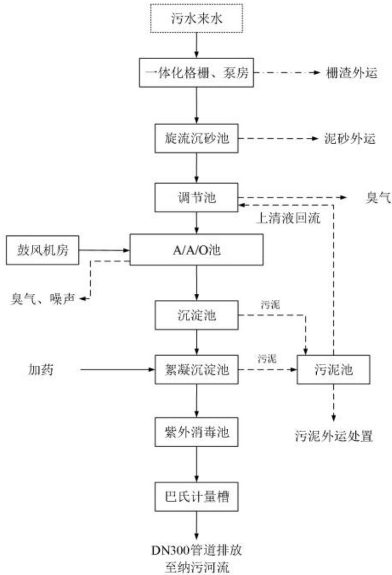
图1 污水处理工艺流程图
